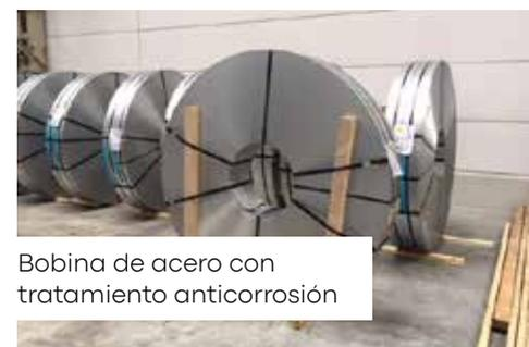
Bobina de acero con tratamiento anticorrosión
