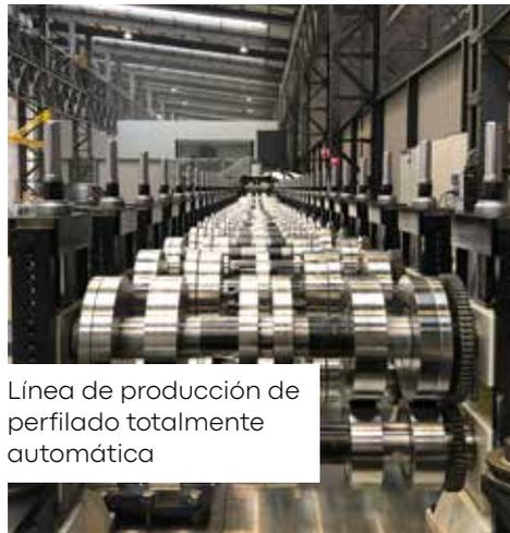
Línea de producción de perfilado totalmente automática
