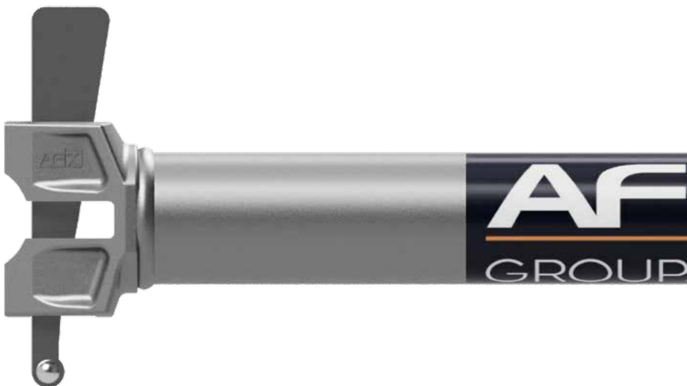
\* Los verticales y horizontales **AFIXFAST** se fabrican en acero S355 de alta calidad con un grosor de pared de 3,2 mm. Este tipo de acero tiene un límite de elasticidad aumentado de 400 N/mm<sup>2</sup> como mínimo y ofrece más seguridad.
